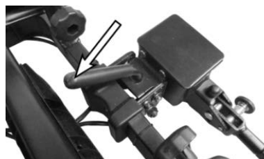
Figura 17: Meccanismo di ribaltamento
