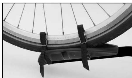
Figure 15 : Sangles de sécurité de la roue avant
