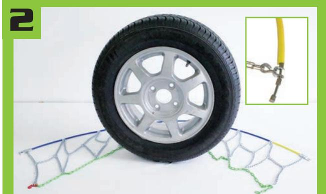
Fr - Faire passer le câble flexible derrière la roue en partant du côté jaune, de gauche à droite. Assurez-vous que le système de re-tension automatique ne teste pas de tension sur le câble.
