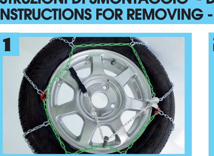
Fr - Faire passer le câble flexible derrière la roue en partant du côté jaune, de gauche à droite. Assurez-vous que le système de re-tension automatique ne teste pas de tension sur le câble.
