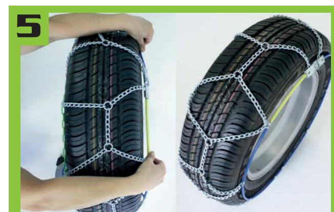
Fr - Faire passer le câble flexible derrière la roue en partant du côté jaune, de gauche à droite. Assurez-vous que le système de re-tension automatique ne teste pas de tension sur le câble.
