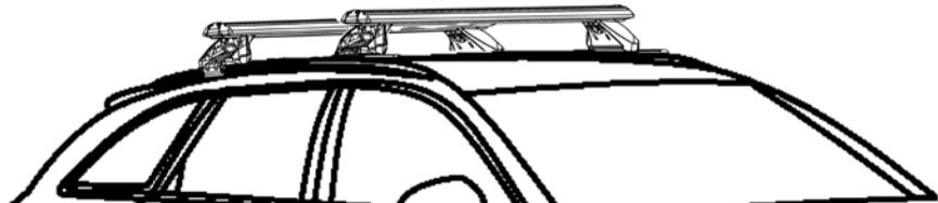
FR : poids des barres de toit + poids du coffre de toit + poids de la charge transportée = Charge de toit effective
